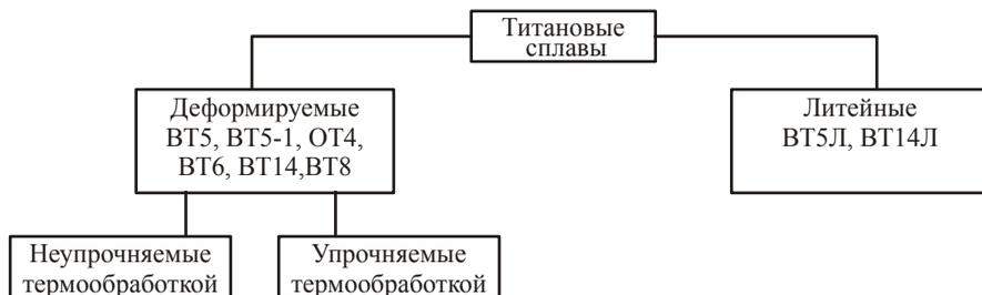
В *литейных* титановых сплавах в конце марки указывается буква «Л», например, BT20Л, BT3-1Л и т.д.
