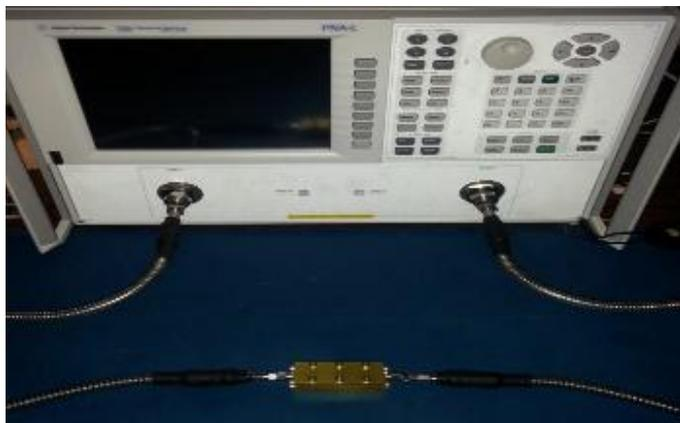
рис.1. Установка для измерения электрофизических характеристик материалов
