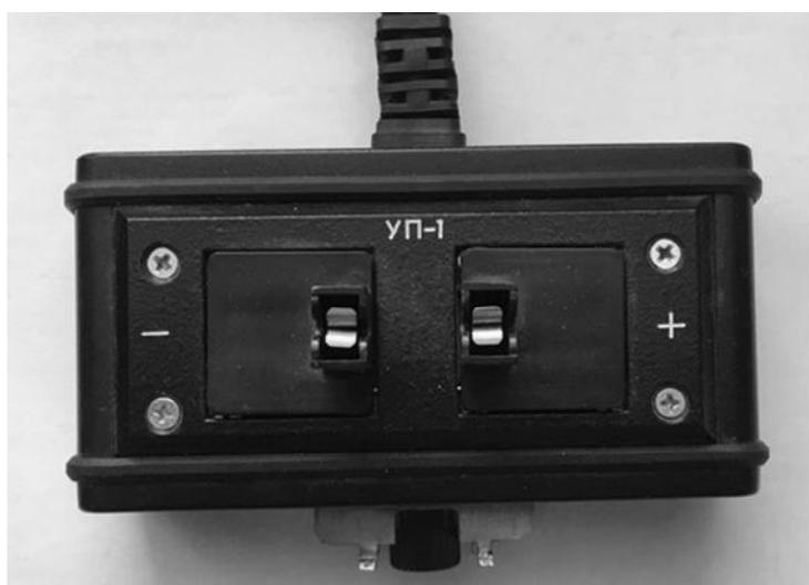
рис. 4 – Устройство присоединительное УП – 1
