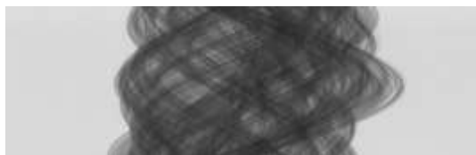
Рисунок 2. Изображение слоев последовательности теневых проекций. Высота изображения в пикселах соответствует общему числу теневых проекций, линия 1 на изображении – слой первой теневой проекции, линия N – тот же слой N-ой теневой проекции
