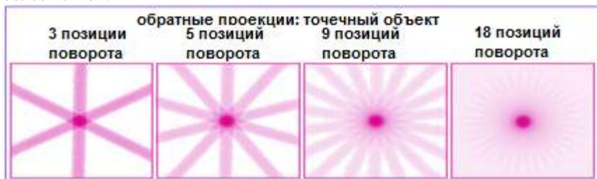
Рисунок 2. Реконструкция точечного объекта с использованием различного числа смещений
